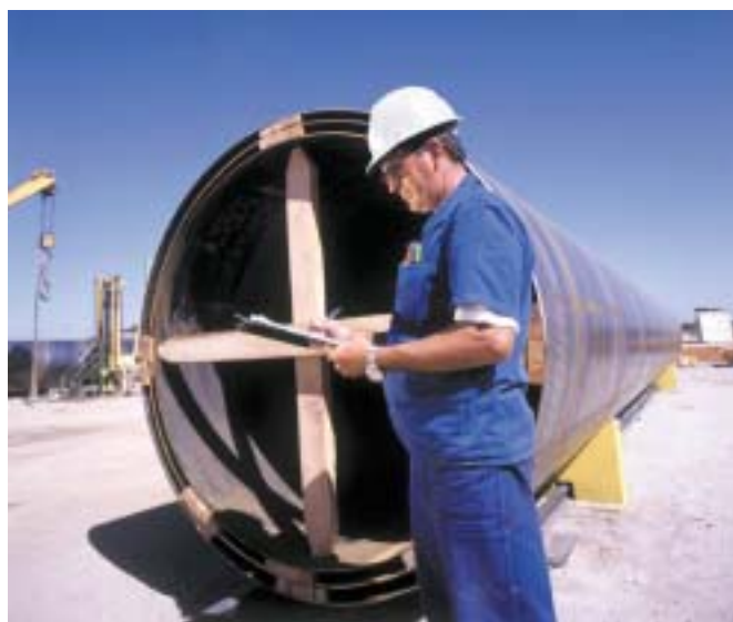
▲ No sistema de telescopagem, dois ou três tubos podem ser embutidos dentro do outro.
