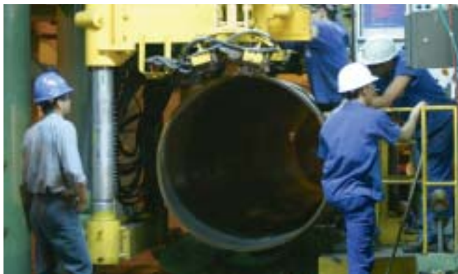
▲ Produção inédita: tubo de 48" produzido na TenarisConfab durante o processo de soldagem.
