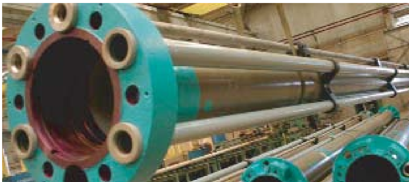
▲ TenarisConfab produz, com exclusividade no Brasil, Marine Drilling Risers com tubos de fabricação própria.
