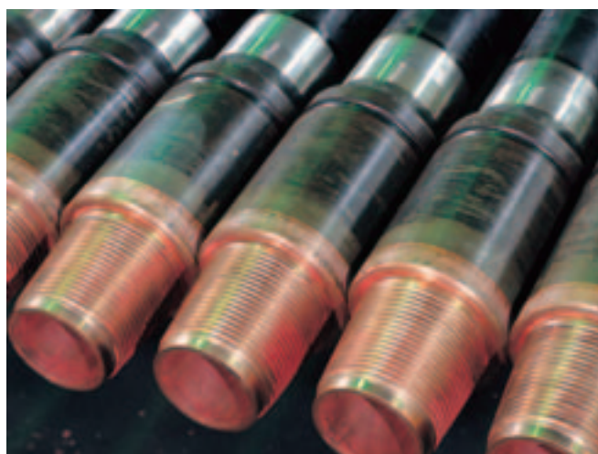
▲ Drill Pipe: tubo de perfuração com conexões API ou proprietárias.
