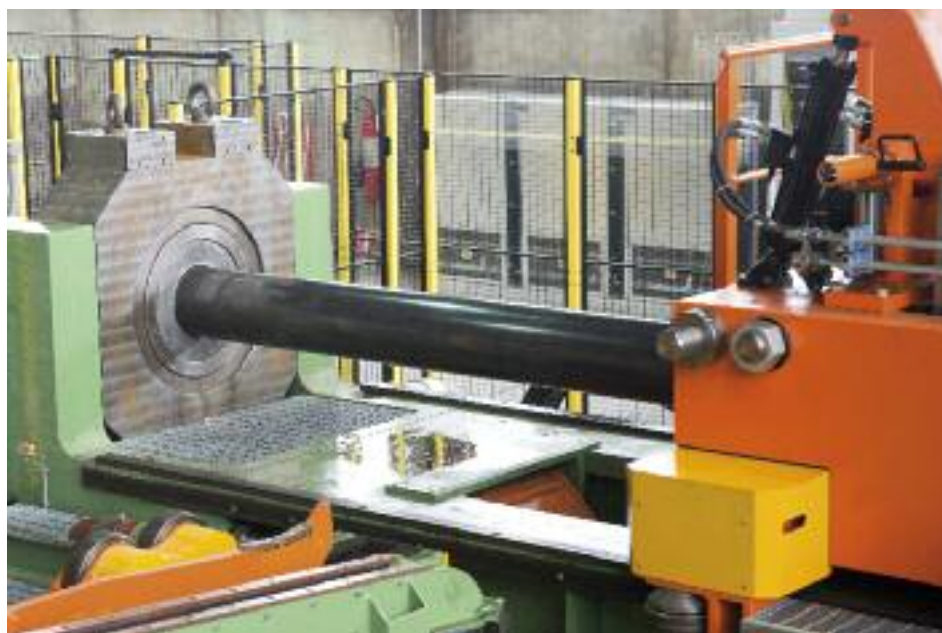
La trafila da 450 tonnellate installata presso lo stabilimento di TenarisDalmine a Costa Volpino.
