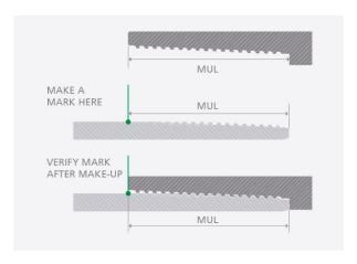
NOTE: IF FOR ANY REASON THE DATA SHEET FOR THE SPECIFIC PRODUCT IS NOT AVAILABLE ON LOCATION THE MAKE UP LOSS CAN BE DETERMINED BY MEASURING FROM THE TORQUE SHOULDER TO THE FACE OF THE BOX, AS ABOVE.
