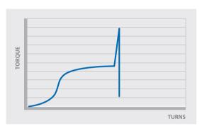
**EXAMPLE - COUPLING ROTATION & PIN - SHOULDER CONTACT**
